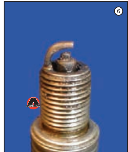
Центральный электрод, его юбка покрыты плотным слоем масла, смешанного с каплями несгоревшего топлива и мелкими частицами от разрушений, произошедшими в этом цилиндре. Причина этого – разрушение одного из клапанов или поломка перегородок между поршневыми кольцами с попаданием металлических частиц между клапаном и его седлом. В данном случае двигатель «троит» уже не переставая, заметна значительная потеря мощности, расход топлива возрастает в полтора, два раза. Выход один – ремонт.
