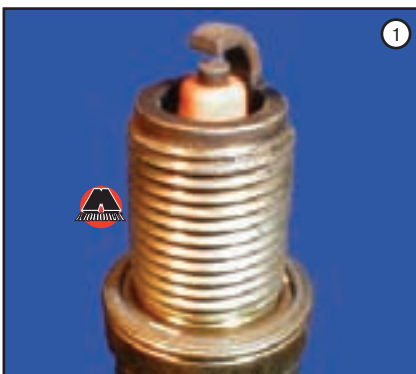
Юбка центрального электрода имеет светло-коричневый цвет, нагар и отложения минимальны. Полное отсутствие следов масла. Владельцу данного мотора можно только позавидовать, и есть чему: это экономичный расход топлива и отсутствие необходимости доливать масло от замены до замены.
