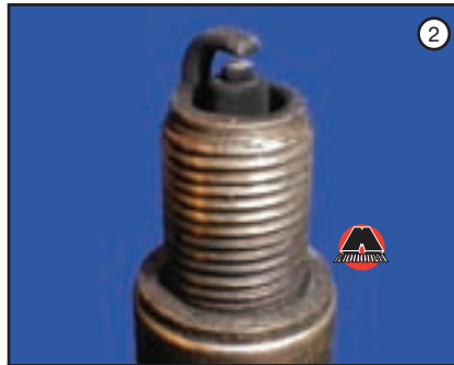
Центральный электрод покрыт бархатисто-черным нагаром. Причин тому несколько: богатая воздушно-топливная смесь (неправильная регулировка карбюратора или неисправность инжектора), засорение воздушного фильтра.
