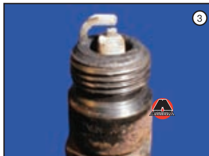
Цвет электрода от светло-серого до белого. Здесь есть повод для беспокойства. Езда на слишком обедненной смеси и при повышенных нагрузках может стать причиной значительного перегрева как самой свечи, так и камеры сгорания, а перегрев камеры сгорания – прямой путь к прогару выпускных клапанов.
