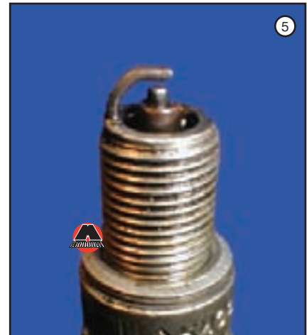
Двигатель с такими свечами после длительной стоянки, имеет обыкновенное после запуска «троить» некоторое время, а по мере прогрева работа стабилизируется. Причина этого – неудовлетворительное состояние маслоотражательных колпачков. Налицо повышенный расход масла. В первые минуты работы двигателя, в момент прогрева, характерный бело-синий выхлоп.
