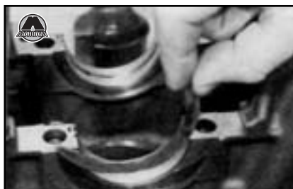
17.17 Установите упорные шайбы на каждую сторону коренного подшипника № 2 таким образом, чтобы масляные канавки были направлены наружу – модели автомобилей, оснащенные двигателем 1,6 л.
