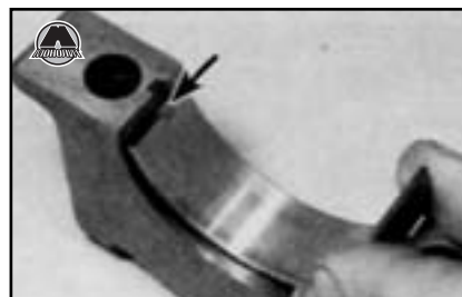
17.18 Убедитесь, что выступ (указан на иллюстрации стрелкой) совместился со срезом при установке вкладышей подшипников – модели автомобилей, оснащенные двигателем 1,6 л.
